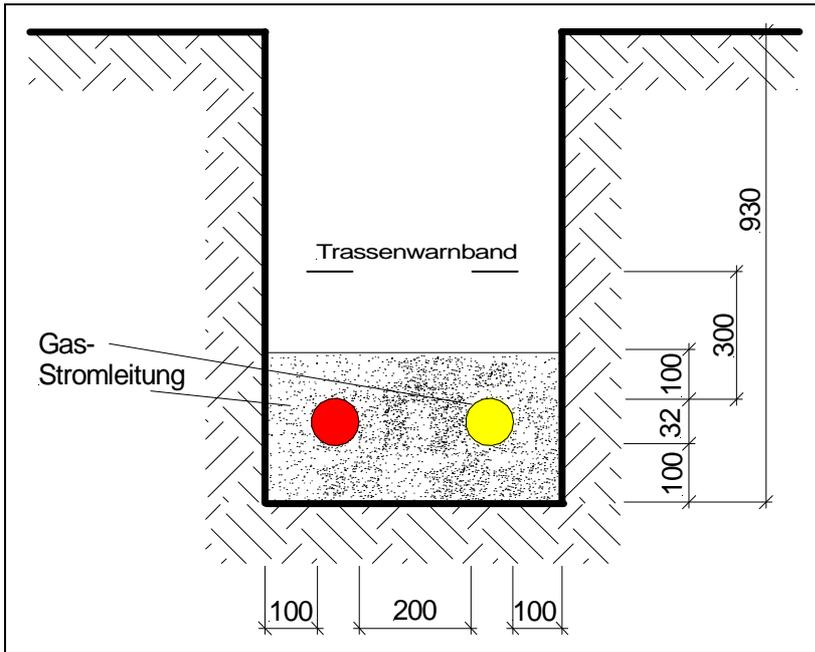
Bild 3: Grabenprofil bei Strom und Gas
