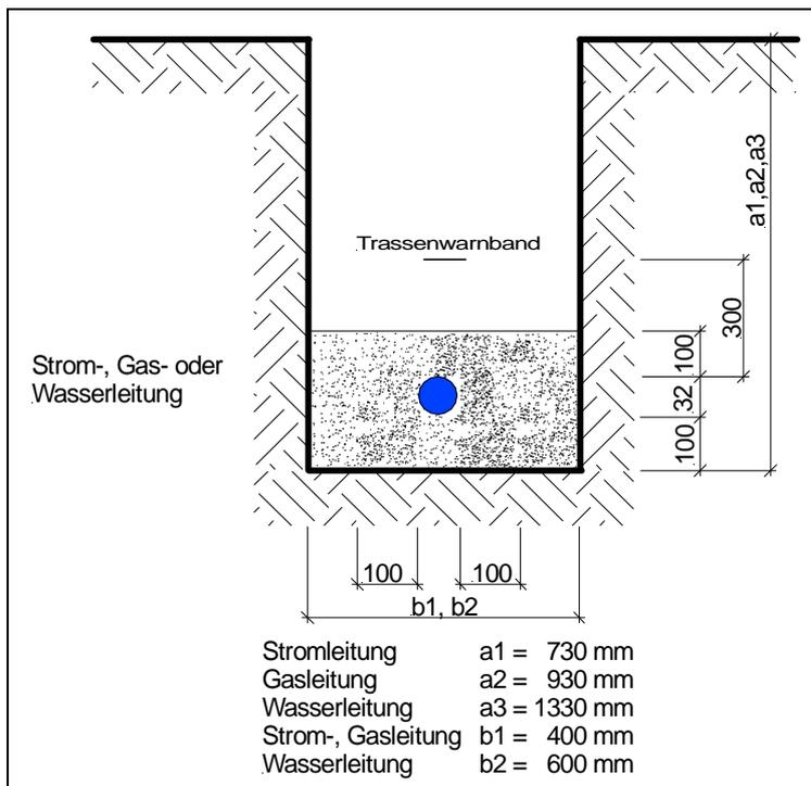
Bild 2: Grabenprofil bei einem Gewerk
