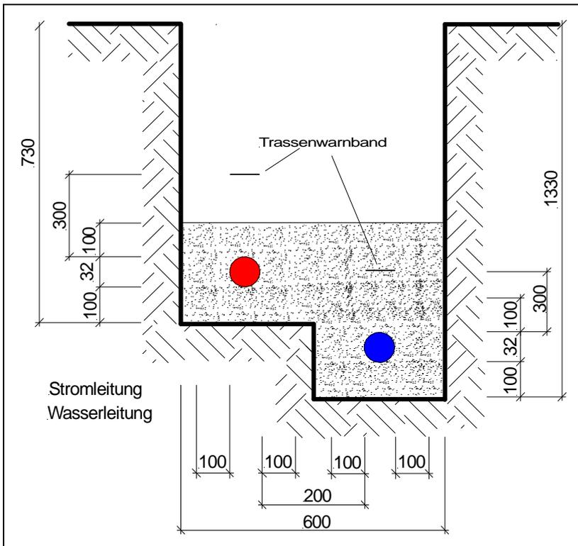
Bild 4: Grabenprofil bei Strom und Wasser
