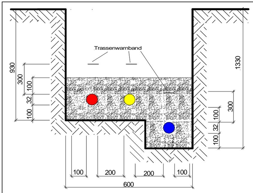
Bild 1: Grabenprofil bei drei Gewerken
